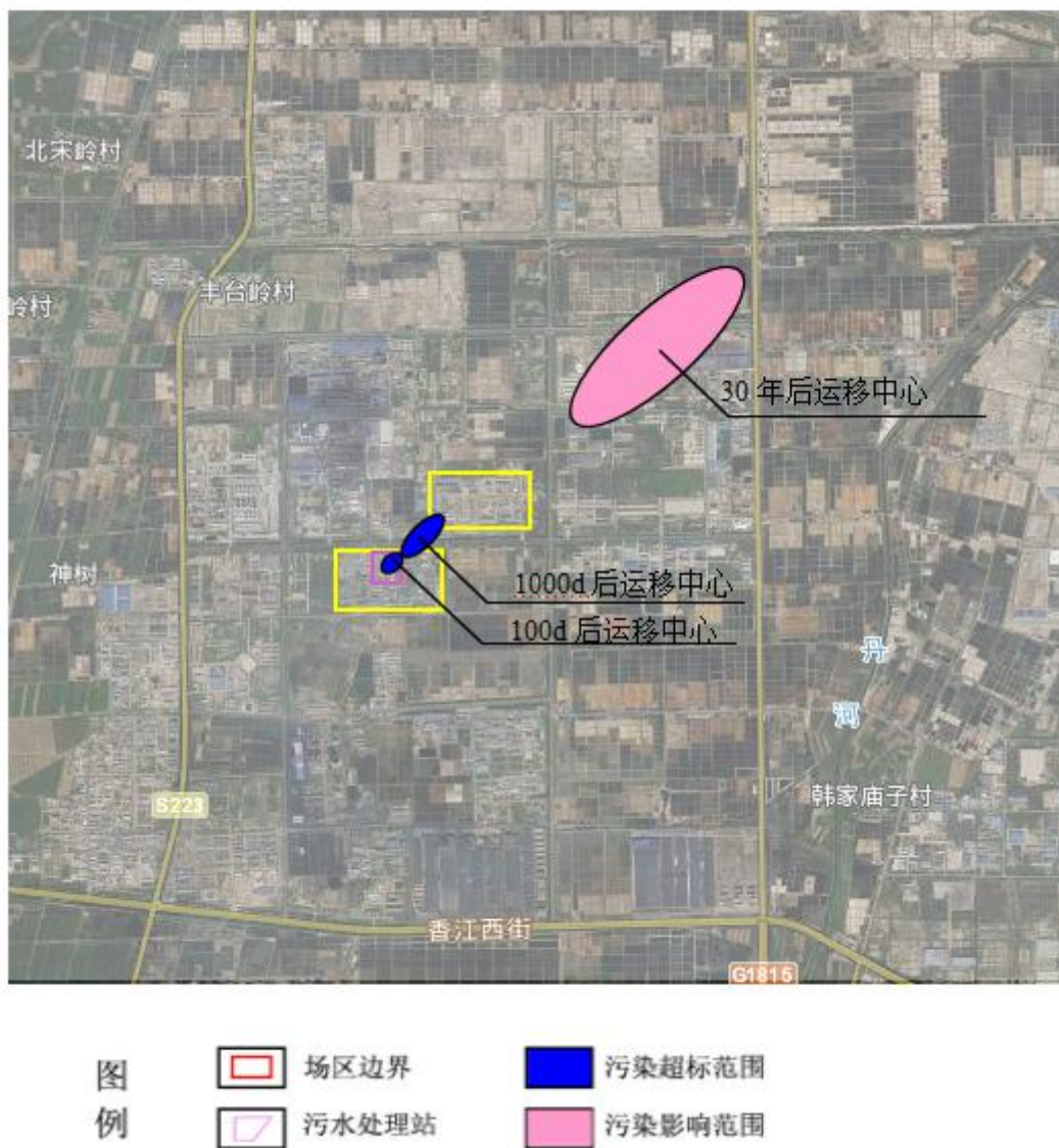
图 5.3-13 事故发生后氨氮的超标范围示意图
